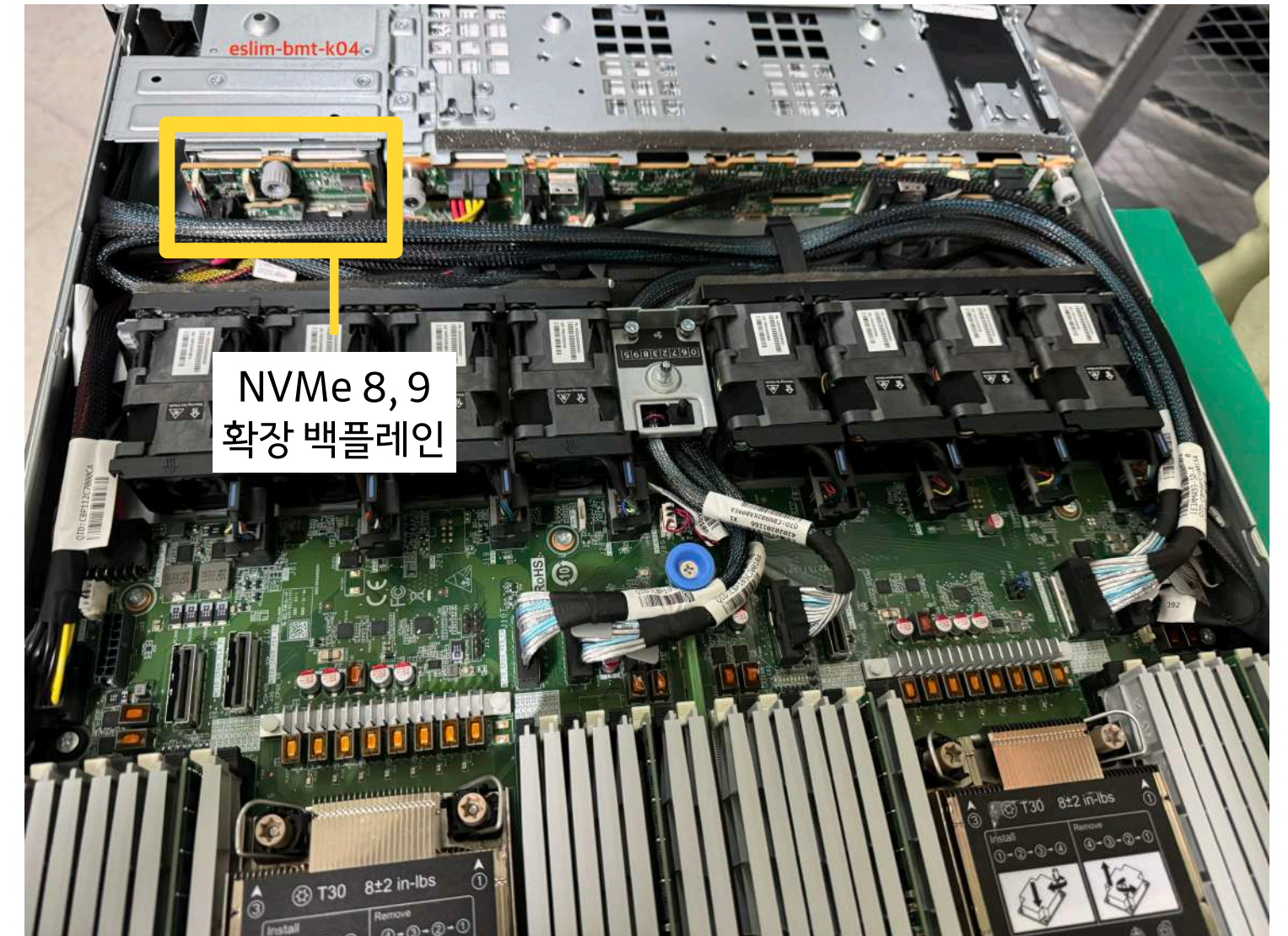
K4_Type (10bay 디스크 장착 백플레인 서버) 의 NVMe 10개 사용 예시
